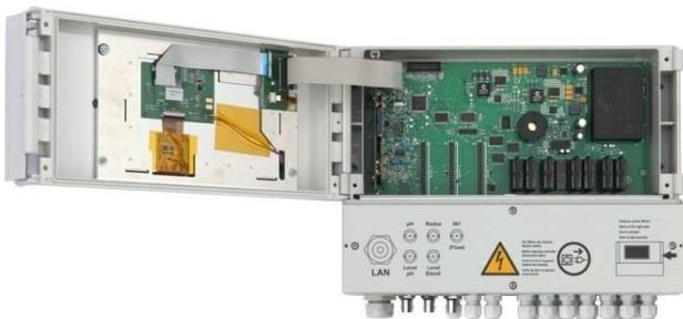
4. Entfernen Sie nun den Klemmraumdeckel, indem Sie die 4 Befestigungsschrauben lösen und entnehmen Sie anschließend die Aluminium-Schiene.
