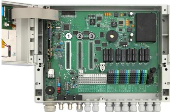
2. Isolieren Sie das bzw. die Kabel für die erforderliche Länge im Geräte-Innern ab und führen Sie es durch eine bzw. mehrere PG-Verschraubungen ins Gerät ein.
