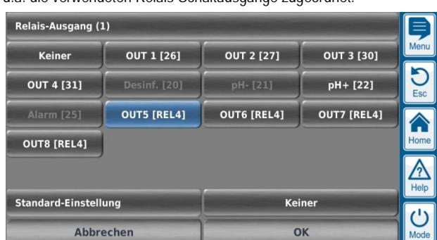
Die Abbildung zeigt exemplarisch ein Menü für die Zuordnung eines Relais-Schaltausgangs.
