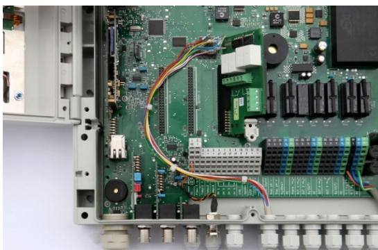
3. Schließen Sie nun die Kabelenden an den Klemmen des PM5-REL-4 Steckmoduls an. OUT5...OUT8 bezeichnen die einzelnen Schaltausgänge, die Sie später im Menü auswählen können. OUT5 und OUT6 sind als Wechselschalter ausgeführt, wie in der Abbildung dargestellt.
