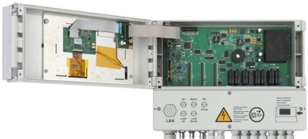
4. Entfernen Sie nun den Klemmraumdeckel, indem Sie die 4 Befestigungsschrauben lösen und entnehmen Sie anschließend die Aluminium-Schiene.
