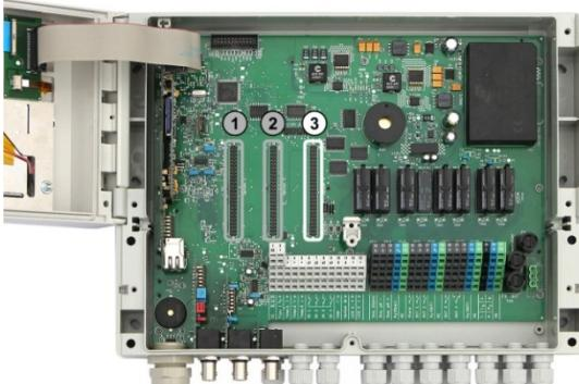
2. Isolieren Sie das bzw. die Kabel für die erforderliche Länge im Gerät-Innen ab und führen Sie es durch eine bzw. mehrere PG-Verschraubungen ins Gerät ein.
