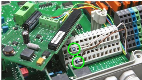
Die zusätzlichen weißen und braunen Kabel sind die Anschlüsse des PT1000 Temperatursensors. Sie können diesen Sensor an einen der Temperatureingänge des PoolManager®/Analyt anschließen:
