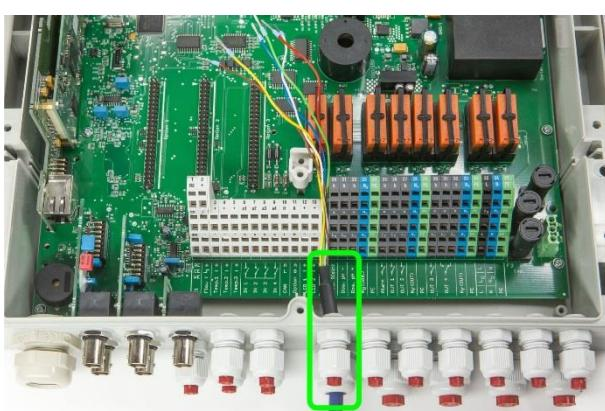
Führen Sie das Kabel durch eine der größeren Kabelverschraubungen ins Gerät ein.
