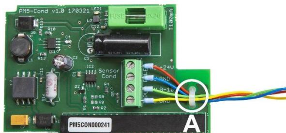
Schließen Sie das Sensorkabel entsprechend der Abbildung an der Anschlussklemme des Steckmoduls PM5-COND an. Führen Sie den mitgelieferten Kabelbinder durch die beiden Bohrungen in der Platine und ziehen Sie ihn fest (A). Dadurch werden die Kabel geführt und zugentlastet.
