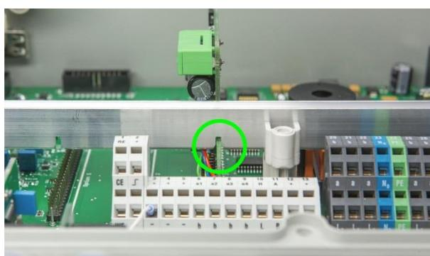
Setzen Sie die Aluminium-Schiene des PoolManager®/Analyt wieder ein und achten Sie darauf, dass das Steckmodul exakt in der dafür vorgesehenen Nut sitzt.
