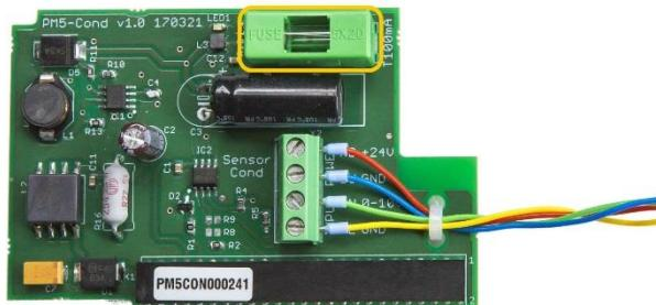
Das Steckmodul PM5-COND ist durch eine Schmelzsicherung 100 mA gegen Kurzschlüsse oder andere Anschlussfehler geschützt. Die Sicherung hat die Dimensionen 20 x 5 mm und kann bei Bedarf leicht getauscht werden.
