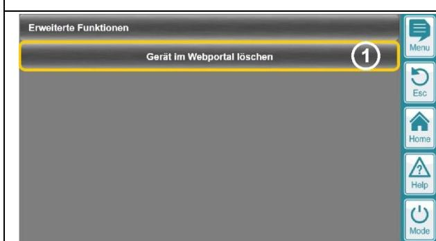
(1) Im Untermenü „Erweiterte Funktionen“ kann das Gerät vollständig und unwiderruflich aus dem Webportal gelöscht werden. Voraussetzung dafür ist eine bestehende Verbindung zum Webportal.
